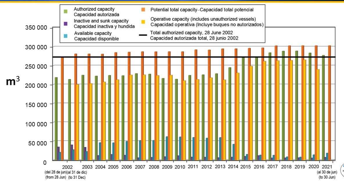
Volumen de bodegas (metros cúbicos) de las principales flotas de buques cerqueros que pescaron en el OPO en 2002-2020 Well volume (cubic meters) of the principal fleets of purse-seine vessels that fished in the EPO in 2002-2020
