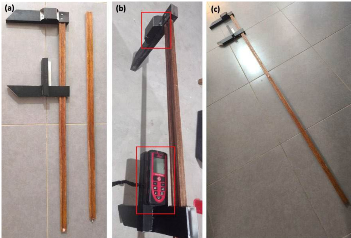
Figura 14. (a) Ictiómetro desmontable de dos metros adaptado a un medidor de distancia con láser para la toma de medidas morfométricas de especies de elasmobranchios en Perú; (b) Los
