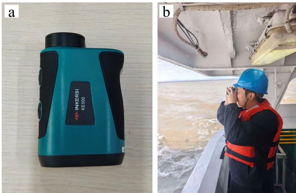
Figura 4 Diagrama esquemático del equipo de medición de la extensión aérea y del procedimiento de medición en campo para la línea tori (a: telémetro láser visual INKERSI KE500; b: investigadores midiendo la extensión aérea en campo)
