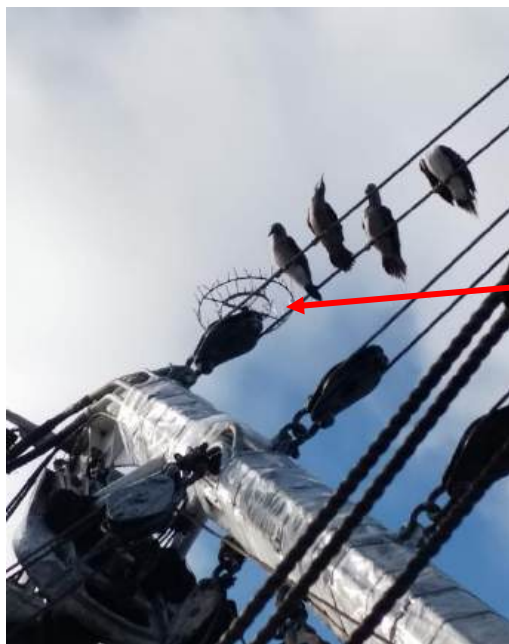
Figura 1. La imagen muestra un ejemplo de dispositivo de protección (flecha roja) construida por los pescadores de un buque de cerco para evitar que las aves marinas, que se refugian en el buque, queden atrapadas y resulten heridas en las líneas de trabajo.
