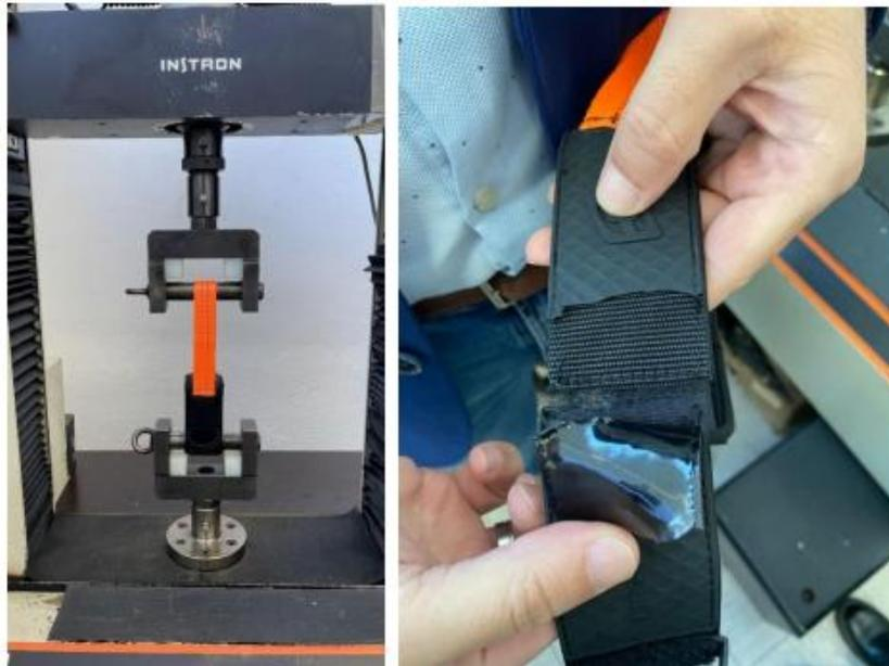
Figura 2. Invento de olas grandes modificado roto en pruebas de carga.
