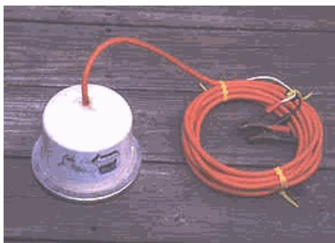
**FIGURA 5.** Transductor y cable de suministro del atractivo sónico. Se coloca el transductor en una jaula de plástico, atado al fondo del mismo, con la salida del cable hacia arriba. Se sujeta la jaula al lado de la lancha; el cable es conectado a la batería de la lancha o a una batería auxiliar.
